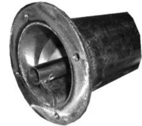
Abb: Schneckenverlängerung mit Flanschverbindung
